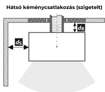
A füstcső áthaladása éghető anyagból készült falon
